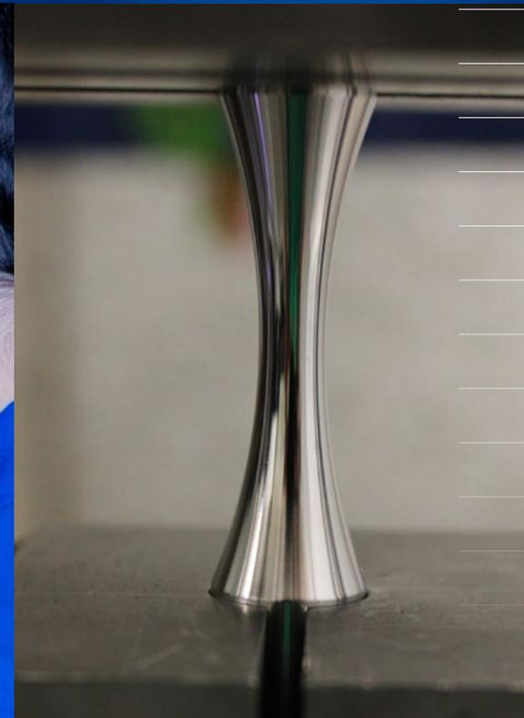
Ermittlung zyklischer Werkstoffkennwerte (Wöhlerkurve, Dauerfestigkeit) bei Raumtemperatur und erhöhten Temperaturen
